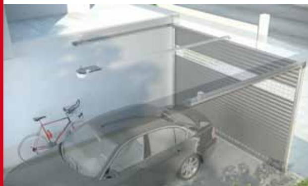
Le modèle **DETOLUX** a seulement besoin d'une hauteur de linteau de **17 cm** pour un montage optimal. Cela signifie donc que même les garages de faible hauteur peuvent être équipés d'un système de porte performant. Lors de l'ouverture et de la fermeture, le tablier de la porte glisse sur des galets parallèlement au plafond, en douceur et en silence.
